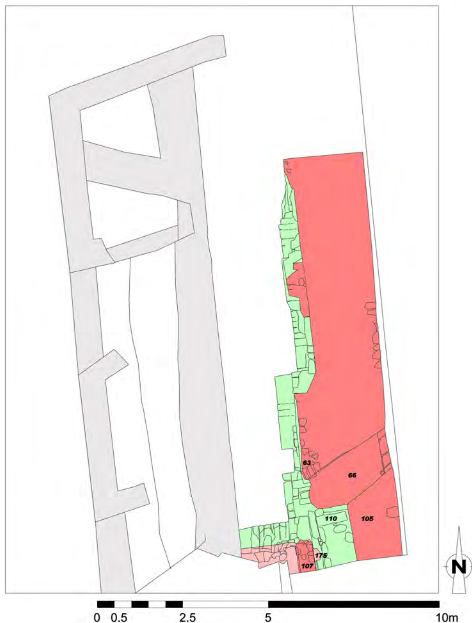
Fig. 10. Esquema de las diferentes fases constructivas en la parte superior de la muralla. En verde, muralla califal omeya, en rojo, reforma manuelina y en gris, muralla real portuguesa.
