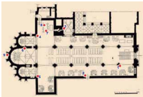
Localização dos sensores de medição ambiental na igreja.
